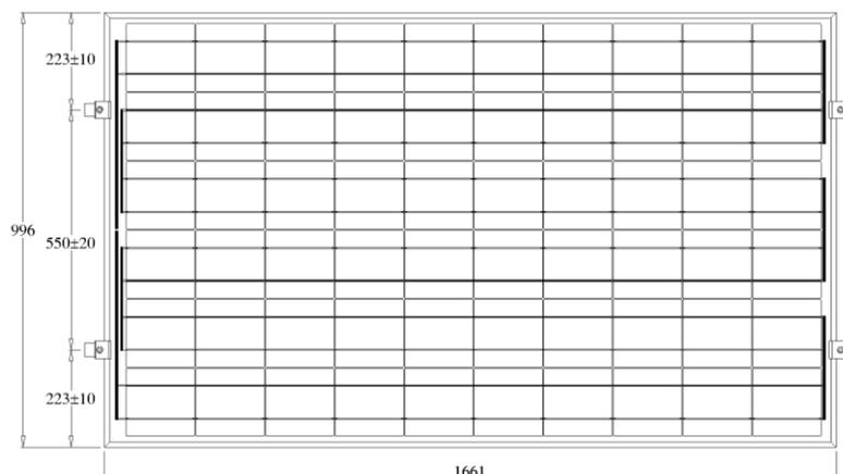
Questa soluzione può essere utilizzata esclusivamente con montaggio del modulo coplanare alla copertura, in zone climatiche tali che il vento non sia in grado di generare una spinta superiore a 50 Kg/mq e non soggette a pesanti nevicate.
